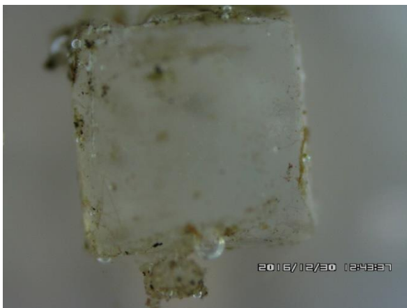
Bild 5: quadratisches, transparentes Plastikteilchen, symmetrisch, gerade, gleichlange Seiten, gebrochener Rand, mit Blaseneinschlüssen, etwa 1mm Kantenlänge, stark mit Algen besiedelt
